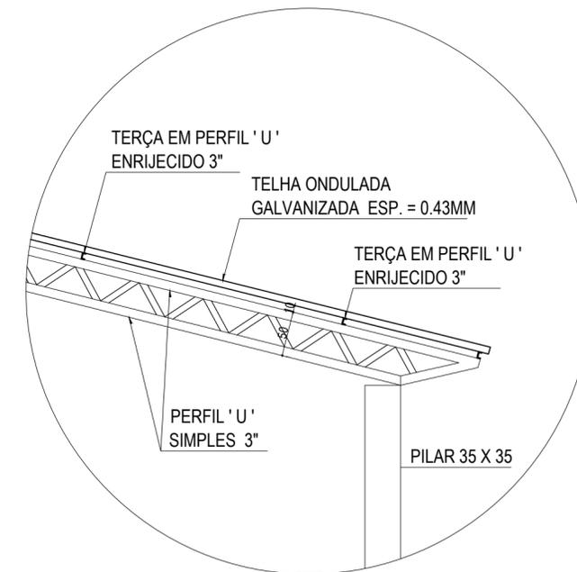
**DETALHE ESTRUTURA TELHADO**
